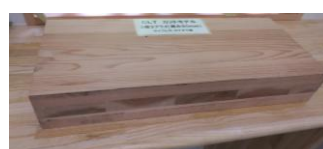
CLTカットモデル (3層3プライ)
