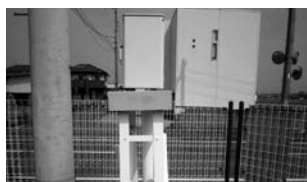
鷹丸に設置された 地下水位の観測井戸
