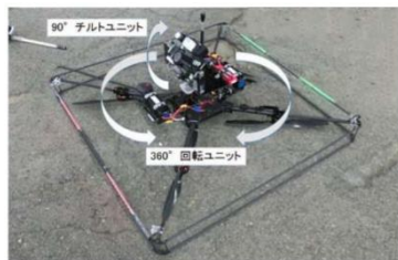
ドローンによる橋梁点検
