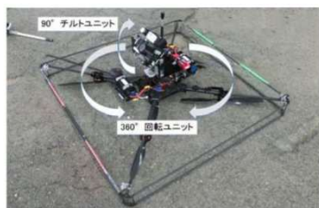
ドローンによる橋梁点検
