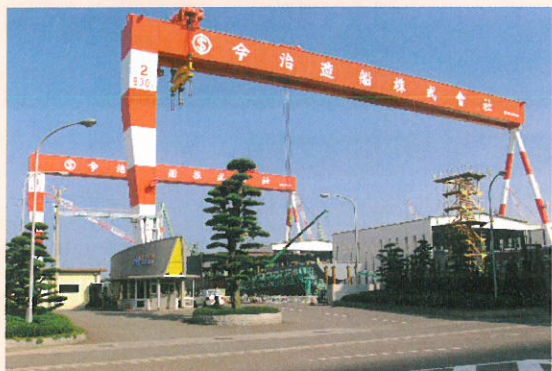
800t吊りクレーン
