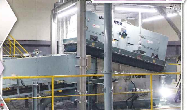
不燃ごみ・粗大ごみを細かくする高速回転破砕機
