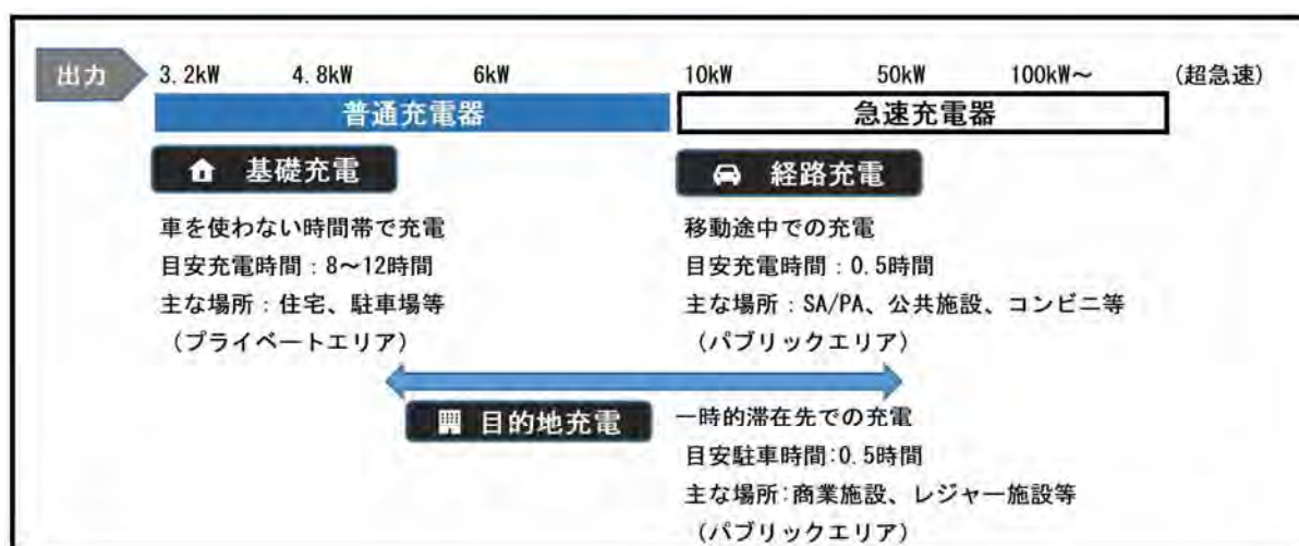
図1 EV車充電設備の概要
