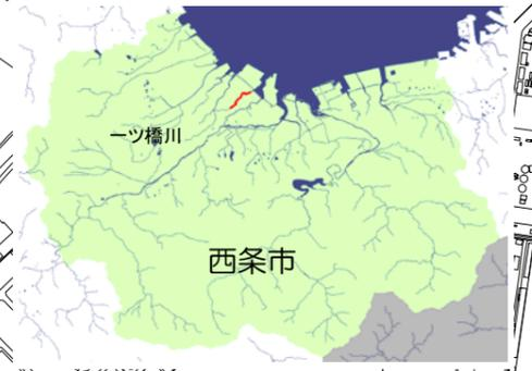
この図は、一ツ橋川流域に50年に1回程度起こる豪雨（日雨量226mm）により、堤防が決壊した場合の洪水氾濫危険区域図です。
