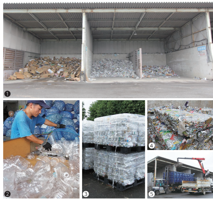
道前クリーンセンターにて。資源になるごみはリサイクル業者に買い取ってもらい、全体で約1,600万円(R1~R3平均)の収入になっています ①左からダンボール、新聞紙、雑誌・雑がみのヤード。別々の収集車が回収に来ます ②③ペットボトルも人が検品し、圧縮します ④⑤缶は磁石でアルミ・スチールに分け、それぞれ集めます
