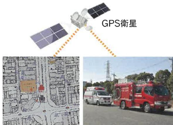
GPS(全地球測位システム)を活用して、リアルタイムに消防・救急車両の位置・活動状況を常時把握しています。これにより、災害地点を特定すると同時に災害現場に最も近い位置の車両から選別して出場部隊を自動的に編成し、最短時間による現場到着をサポートします。指令台や車両運用端末と連動し、各車両の動態情報を一覧表示します。
