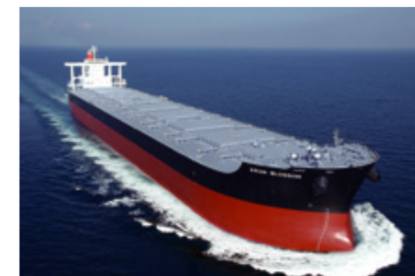
180,000トン型撒積貨物船 全長 291.98メートル 載貨トン数181,494メトリックトン 幅 45.00メートル 総トン数 92,756 深 24.70メートル 航海速力 約15.15ノット
