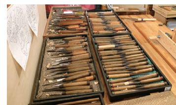
彫刻に使用する200本以上のノミ。使い分けて繊細な彫りとなる
