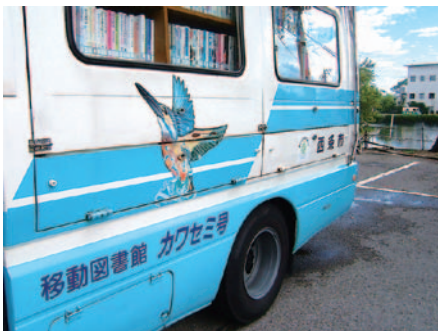
使用済み天ぷら油から精製したバイオディーゼル燃料で走るカワセミ号（移動図書館）
