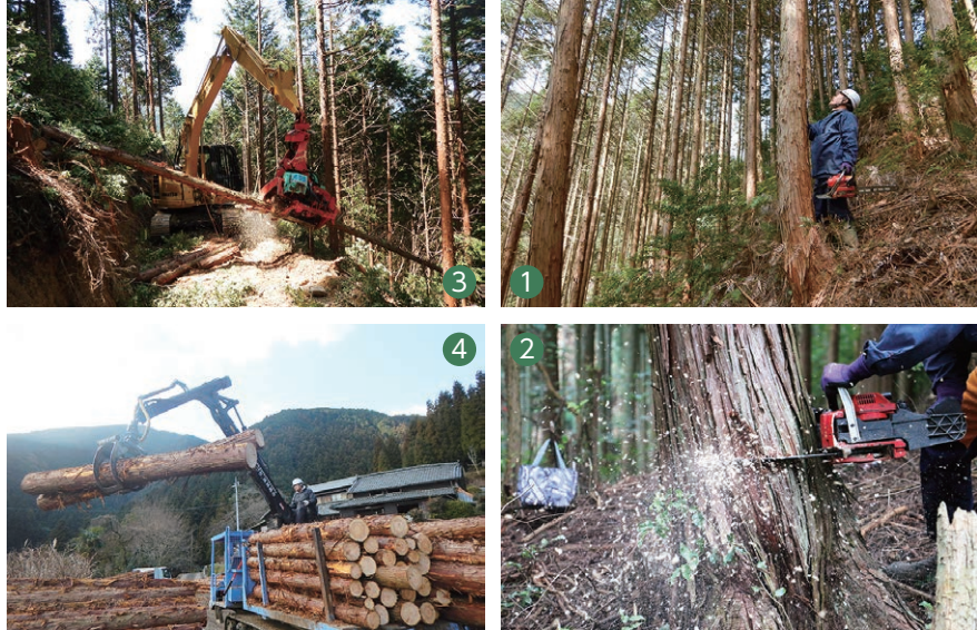
1.適切な間伐をするために切る木を選択 2.選んだ木を伐採 3.プロセッサで枝を切り払い、長さをそろえるなど造材作業 4.フォワーダで木をトラックに積み込み
