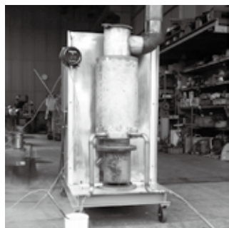
▲ 自社で開発した廃油燃焼装置
