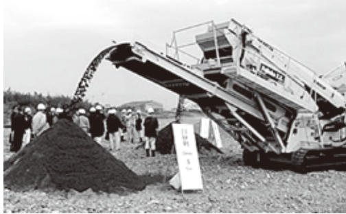
藤岡建設(株)の移動式建設廃棄物粉碎機モービルクラッシャー
