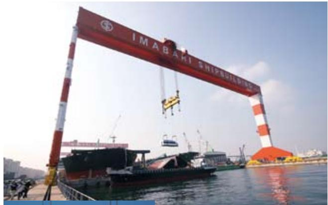
▲翌朝、今治造船西条工場に到着した0系新幹線は、日本最大級の800t クレーンに吊り上げられてトレーラーへ。
