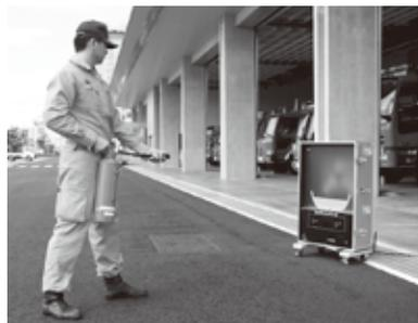
▲光センサーで消火の効果が確認できる消火訓練用の器材。
