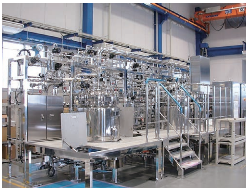
▲一色さんが設計した製薬用の原材料を混ぜる設備
