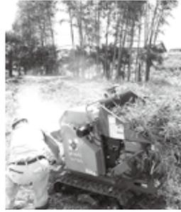
▲小型移動式チップパーによる竹の粉碎処理
