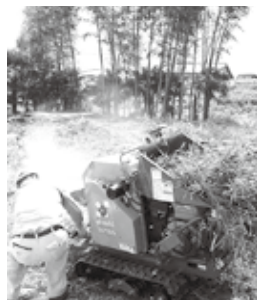
▲小型移動式チップパーによる竹の粉砕処理
