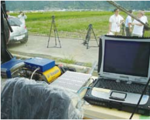
▲GPS精度検証用機材を装備したトラクタの運転席
