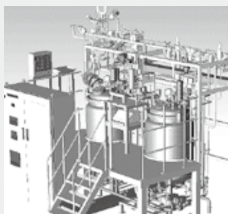
圧力容器・タンク及びユニット配管の3DCADによる設計(写真左)と製作品(写真右)
